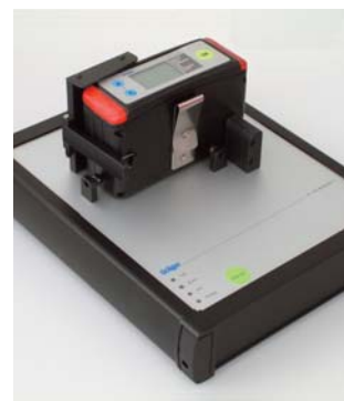
Module E-Cal Calibrage automatique et documentation.
