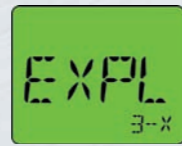
Explosimètre 3 échelles : PPM, % LIE, % Vol. Gaz
