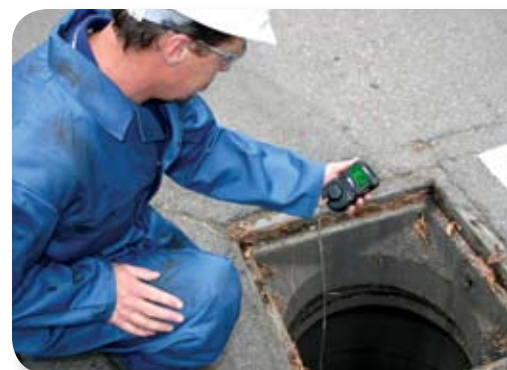
QRAE II utilisé avec sa pompe intégrée dans le cadre d'une analyse en espace clos
